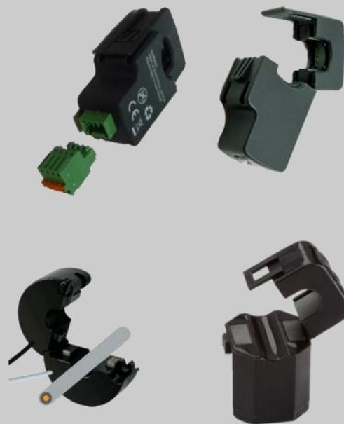
Les transformateurs ouvrants type « Tio » ont été conçus pour permettre une surveillance peu couteuse des circuits électriques. La charnière unique avec mousqueton de blocage permet d'instrumenter un circuit sans interrompre le courant primaire. Leur conception autorise des niveaux de sortie allant jusqu'à 1V alternatif sans amplification. L'excellente linéarité permet la mesure de courants inférieurs à 10 mA.
